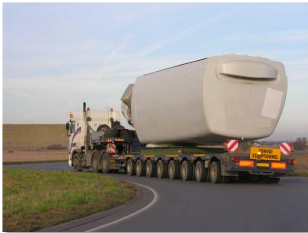
Transport de nacelle (Photo : VALOREM)
